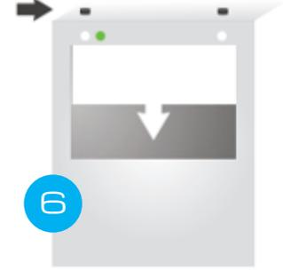
Nach 2 Minuten wechselt die LED-Lampe auf Grün. Öffnen Sie die Luke mit dem Touch-Free-Sensor.
