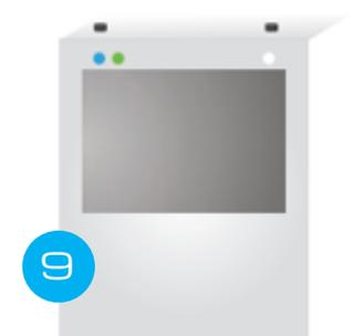
Leuchten die blaue und grüne LED-Lampe gleichzeitig, nullstellen Sie die Box, indem Sie beide Hände gleichzeitig 10 Sek. über die beiden Sensoren halten.
